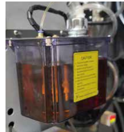
Sistema de pulverização de névoa (2 L)
