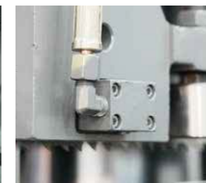
Fixação hidráulica do guia da serra
