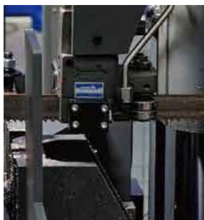
Fixação hidráulica do guia da lâmina
