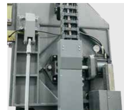
Tensionamento hidráulico da lâmina
