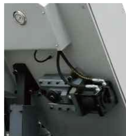
Tensionamento hidráulico da lâmina
