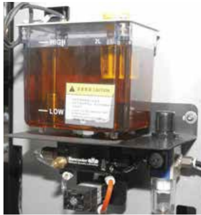
Sistema de pulverização de névoa (2 L)
